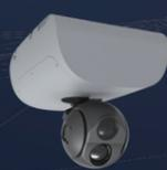
红外探测器类型:非制冷红外微测辐射热计
